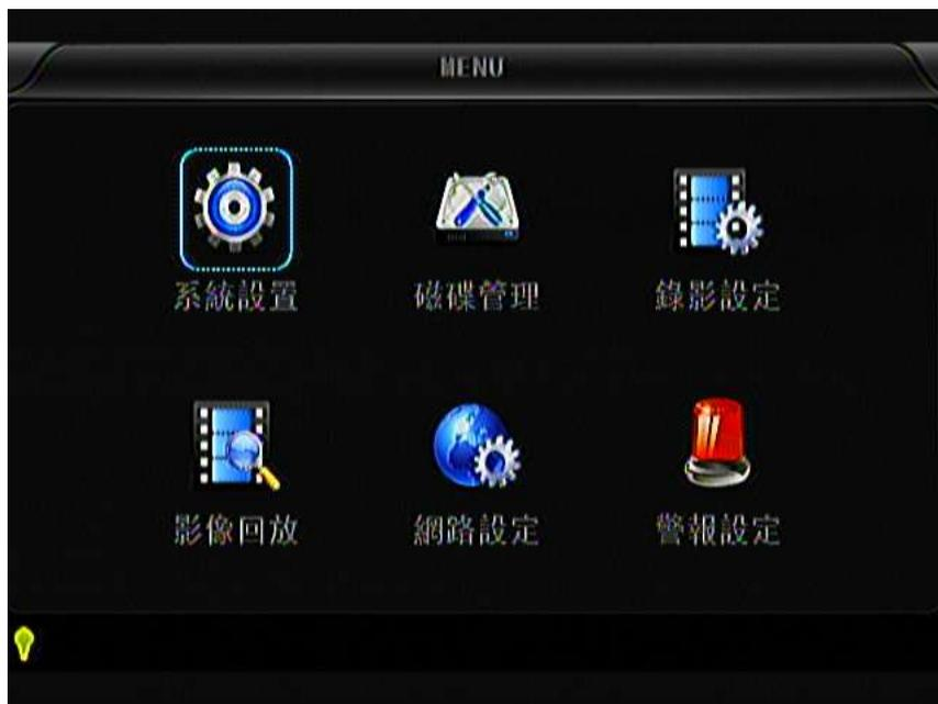
包含“系統設定”、“磁碟管理”、“錄影設定”、“搜索回放”、“網路設定”、“警報設定”6個設定項，用遙控器上的“▲、▼、◀、▶”將游標移動到對應設定項，按“OK”即可進入該子功能表。滑鼠直接點擊圖示進入。
