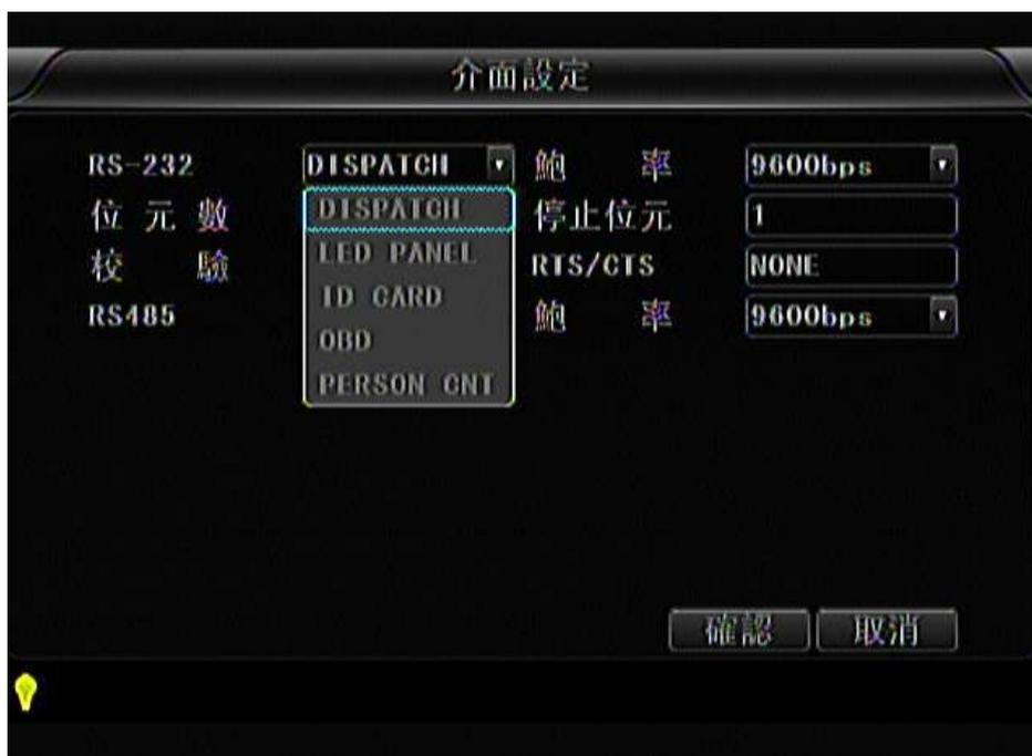
點擊下拉式功能表有“公車調度屏 (DISPATCH)”、“LED 控制台 (LED PANEL)”、“ID 讀卡器 (ID CARD)”、“OBD”、“人數統計儀 (PERSON CNT)”等多個選項。比如你想用 RS-232 介面接人數統計儀，則選擇“人數統計儀 (PERSON CNT)”。
