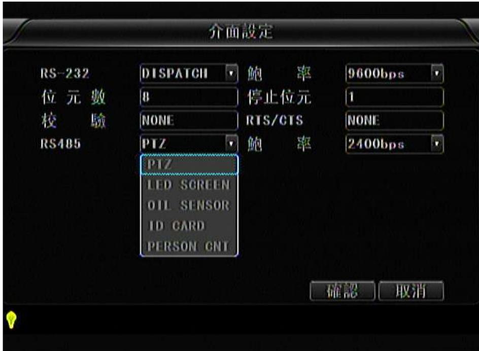
點擊下拉式功能表有“雲台（PTZ）”、“LED 控制台（LED PANEL）”、“油量感測器（OIL SENSOR）”、“ID 讀卡器（ID CARD）”、“人數統計儀（PERSON CNT）”等多個選項。比如你想用 RS-485 介面接人數統計儀，則選擇“人數統計儀（PERSON CNT）”。
